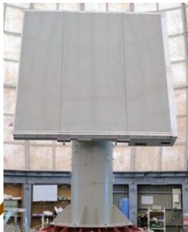
大阪大学・吹田キャンパスに2012年に設置されたフェーズドアレイ気象レーダー（左、設置工事の様子）とそのアンテナ部分（上）。半径20～60km、高度14kmの詳細な降水分布が観測できる。従来5分以上かかっていた観測をわずか10～30秒に短縮した。 （写真：情報通信研究機構）
