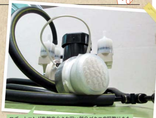
ロボットハンド先端の小さな円い部分がタコの吸盤にあたる部分。軟らかくて、でこぼこ面にも優しくフィットする。
