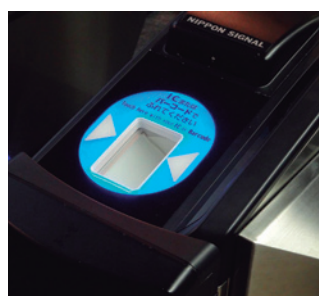
読み取り部に空気の吹き出し口があり、爆発物の成分を瞬時に特定。
