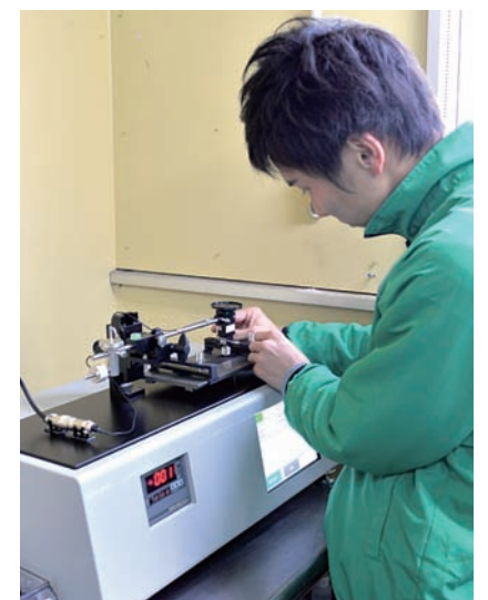
社内で滑走面の摩擦力を計測する八重樫さん。
