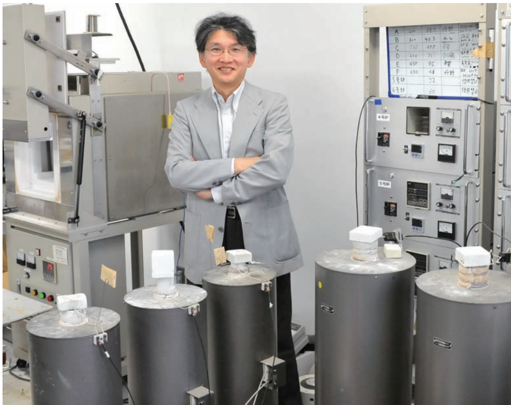
実験室の電気炉と。手前は細めの棒状のサンプルを加熱するもの、奥は太い素材も入れることができる大型炉だ。
