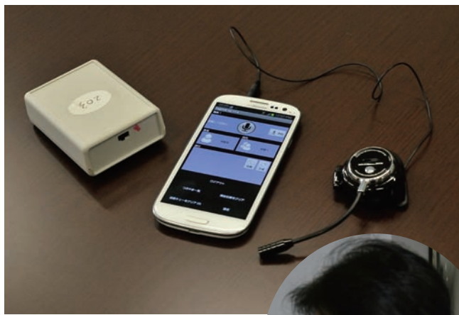
ワンタッチで発信できるヘッドセット(右)とスマートフォン(中)を装着して、「つづやき」を送信。さらに屋内に配置したBluetooth発信器(左)で発信者の位置情報も記録される。
