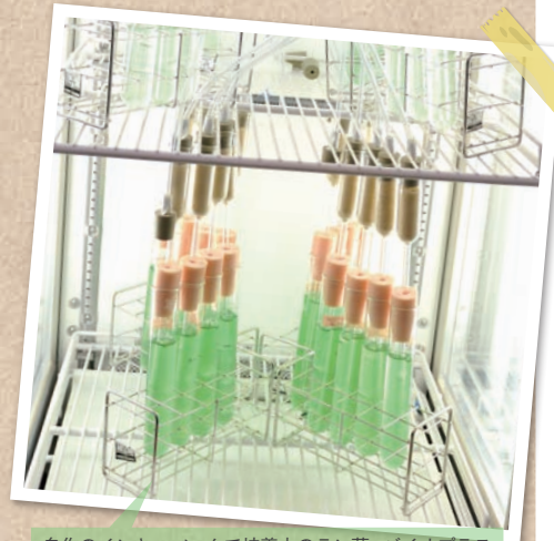
自作のインキュベータで培養中のラン藻。バイオプラスチックを作らせるためにチューブでCO 2 を送り込む。
