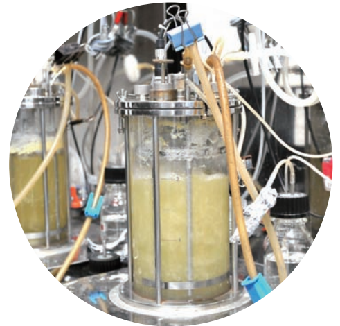
温度や栄養、pH、通気量などを一定に保ちながら微生物を大量に培養する装置を使い、バイオプラスチックをつくり出す微生物の改良を進めている。
