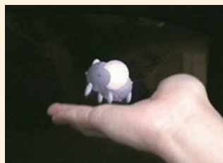
篠田さんらが2009年に開発した「非接触触覚インターフェース」。空中に表示した立体映像に同期して触覚刺激を行う装置の試作例。
