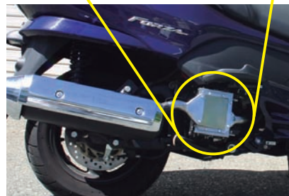
円筒形の複合体（左上）と複合体320本をつなげた排ガス発電システム（右上）。下はオートバイに取り付けたところ。
