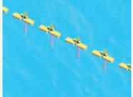
将来の波力発電ファームの構想図。600m×23mの範囲に100kWのジャイロ式発電装置を20基並べ、2MWシステムとすることを想定している。
