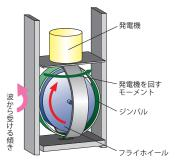
2011年に和歌山県・周参見漁港沖で実施された海上実験の概要図。発電装置は海岸から200m以上沖合に係留され、発電された電力は海底ケーブルで地上局に送られる。
