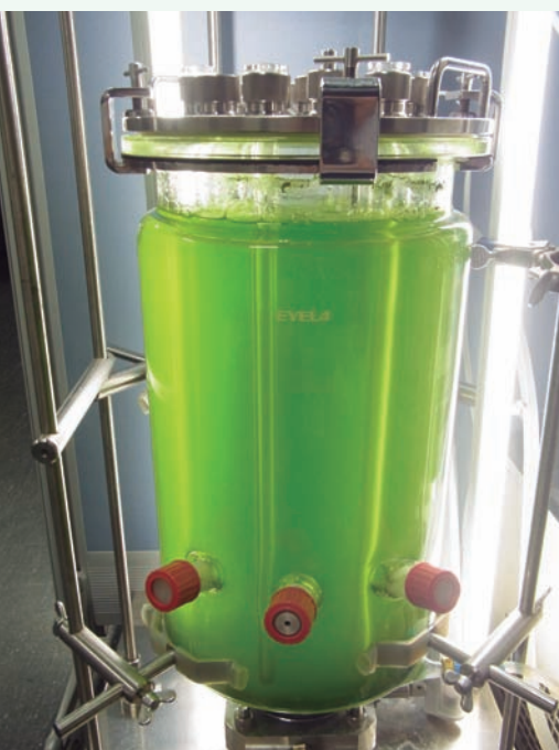
光合成に必要な光源が設置された、屋内用の大型培養装置で育成されるユーグレナ。
