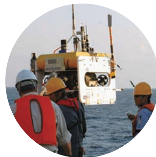
海洋調査船「かいよう」(海洋研究開発機構)のクレーンで海面に降ろされる「TUNA-SAND」。
