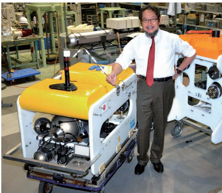
これまで数多く自律型の中ロボットを開発してきた。左は海中ロボット「TUNA-SAND」。
