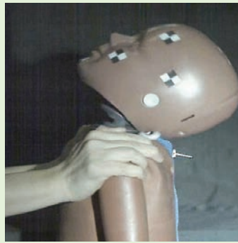
乳幼児の虐待の中でも脳に重い損傷を負いがちな「揺さぶられっ子症候群」。その際に頭部に加わる力を、ダミー人形を使った生体力学シミュレーションで再現し、不慮の転倒や落下で頭部に加わる力との違いを明らかにした。虐待の判別につながる技術である。
