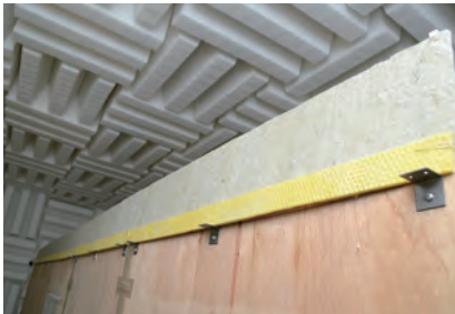
プレート板に多孔質材を取り付けた様子。
