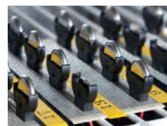
正極に硫黄+炭素、負極にリチウム、電解質にイオン液体を積み重ねて作られた試験用のセル（ボタン電池）。
