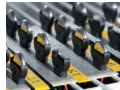
正極に硫黄+炭素、負極にリチウム、電解質にイオン液体を積み重ねて作られた試験用のセル（ポタン電池）。
