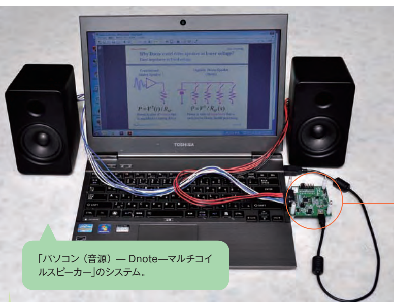
Dnote処理用LSI（中央のチップ）を搭載したボード。この7mm角のチップの中で要となる複雑なプロセスを高速処理している。
