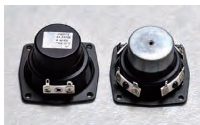
左/アナログ方式のスピーカー駆動部。 右/デジタルスピーカー（マルチコイル型）の駆動部。4つのコイルが内蔵されているため、4つの端子があるのが特徴だ。
