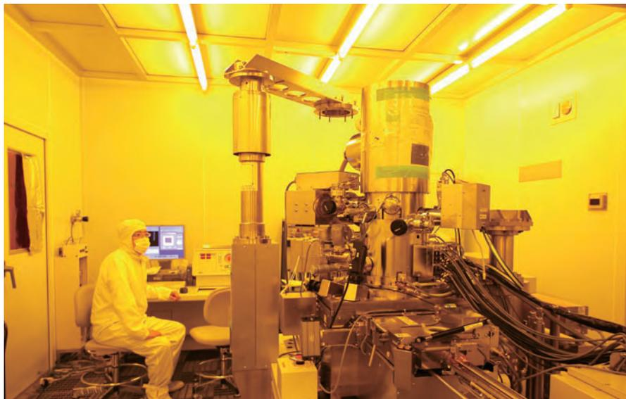
数十ナノメートルという超微細な穴を作成するための電子線リソグラフィ装置。紫外線を嫌う工程のため、紫外線をカットしたイエローランプの部屋で作業する。
