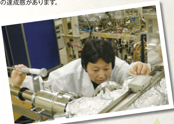
超高真空スパッタ装置で スピントロニクス素子 作製中。
