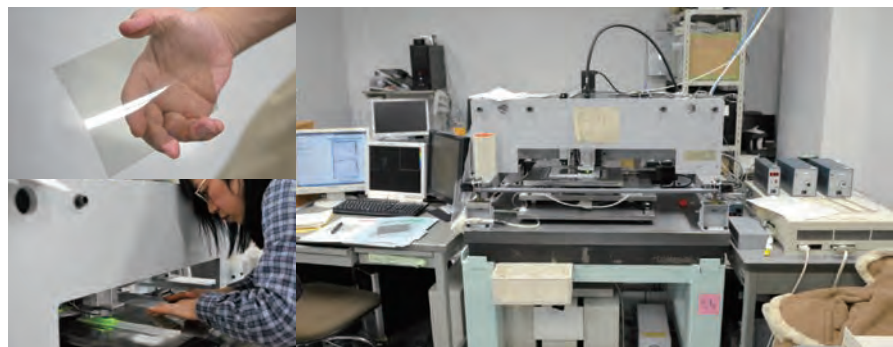
厚さ44マイクロメートルの原子核乾板(左上)を装置にセットし(左下)、乾板を移動させながら顕微鏡で拡大し、1秒間に50枚もの撮影速度で読み取る。
