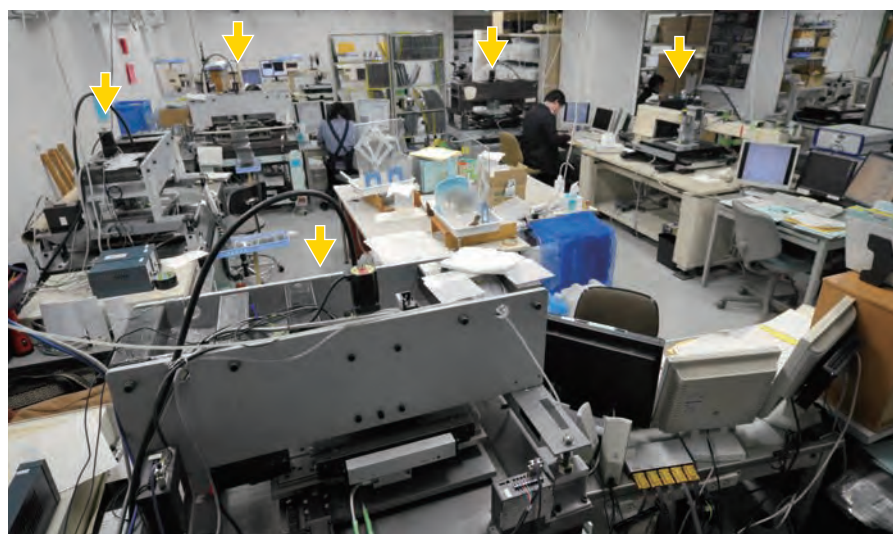
研究室で発明・開発してきた5台の超高速自動飛跡読み取り装置(うち4台は世界最高速)がある(矢印)。1998年のタウニュートリノ発見に貢献し、その後も進化し続けるこの装置が大型構造物を透視する武器となる。
