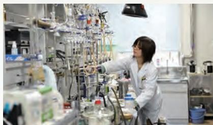
ポリマーブラシ製造装置。ブラシのタネを植え付けた基板を反応溶液に入れ、ブラシを成長させる。
