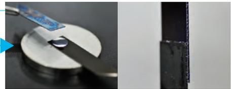
2枚の板に水をはさんで乾かすと互いが接着し、5kgの重さにも耐える。一方の板には正、もう一方には負の電荷をもたせたポリマーブラシを成長させている。
