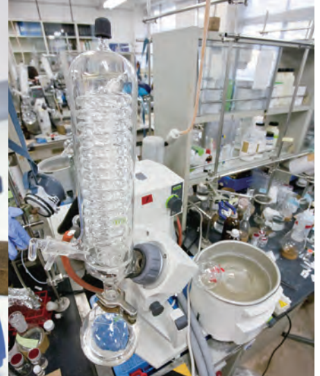
フラスコを連続回転させ、溶媒の除去効率を高めるロータリーエバポレーター。反応に最適な溶媒配合の探索も繰り返し行った。
