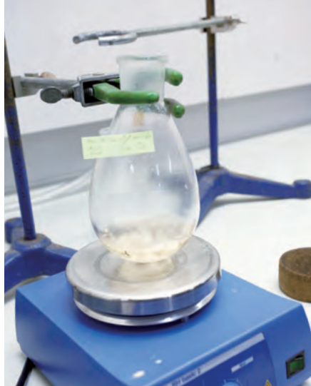
マグネティックスターラーを用い、一定の速度で攪拌する合成反応ステップ。このステップにおいても飛躍的な反応効率アップを図った。
