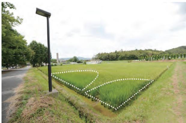
装置内で効率的に影響評価を行う手法を開発しました。さらに、この手法により、光源の波長や各種発光条件の組み合わせによる光害の有無を評価することで、花芽形成を阻害しない最適な照明による光害防止技術を確認しました。
