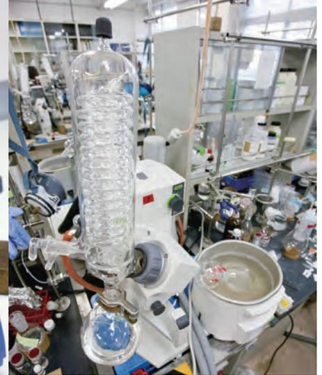
フラスコを連続回転させ、溶媒の除去効率を高めるロータリーエポレーター。反応に最適な溶媒配合の探索も繰り返し行った。
