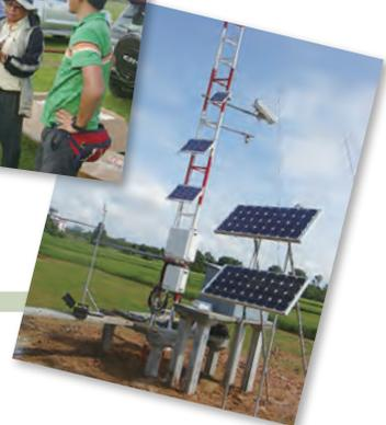
「フラックス」とは、ある時間にある面積で推移する物質やエネルギーの量のこと。水に限らず、二酸化炭素の推移も同時に観測できる機器を設置して、水循環だけでなく炭素循環について解明し、気候変動や地球環境の研究にも取り組んでいる。
