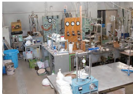
さまざまな機器が並んだ実験室。室内で土壌の様子を再現し、温度などの条件の変化による土壌内物質の挙動への影響などをシミュレーションする。
