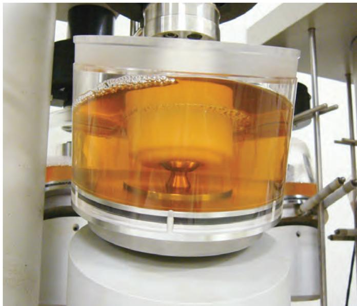
股関節にかかる重量は一定ではない。たとえば、体重70kgの人であれば、70～350kgの重量がいろいろな方向にかかっている。このシミュレーターでは、そうした重量の変動も再現して、実験する。
