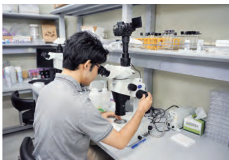
キュービック液晶法による結晶化装置(写真左)。最適な条件下で脂質と膜たんぱく質を混ぜ合わせると結晶化する。できた結晶は顕微鏡で確認してすくい取る(写真中、右)。
