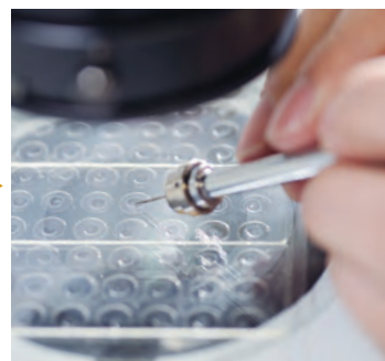
キュービック液晶法による結晶化装置(写真左)。最適な条件下で脂質と膜たんぱく質を混ぜ合わせると結晶化する。できた結晶は顕微鏡で確認してすくい取る(写真中、右)。
