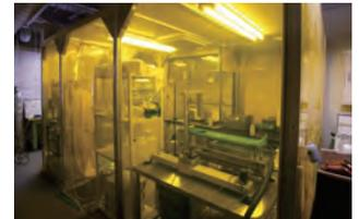
実験室の一角に設けられ、紫外線をカットした環境での実験を行う。
