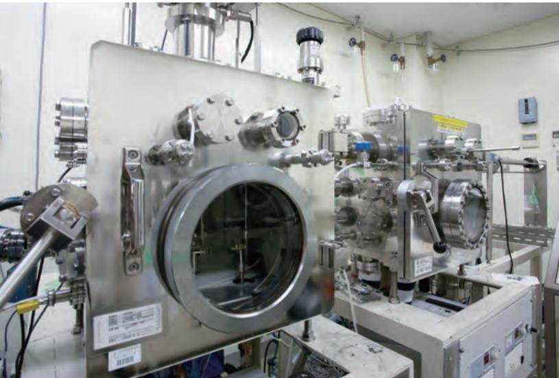
るつぼの中に入れた材料を真空蒸着によって結晶化し、薄膜を作製する。温度や蒸着速度を変えて分子構造を制御することで、有機物のもつ強誘電性が引き出される。
