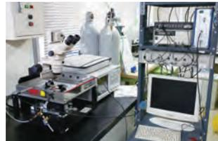
ON-OFFが切り替わるスイッチングスピードなどの電气的特性を計測する。
