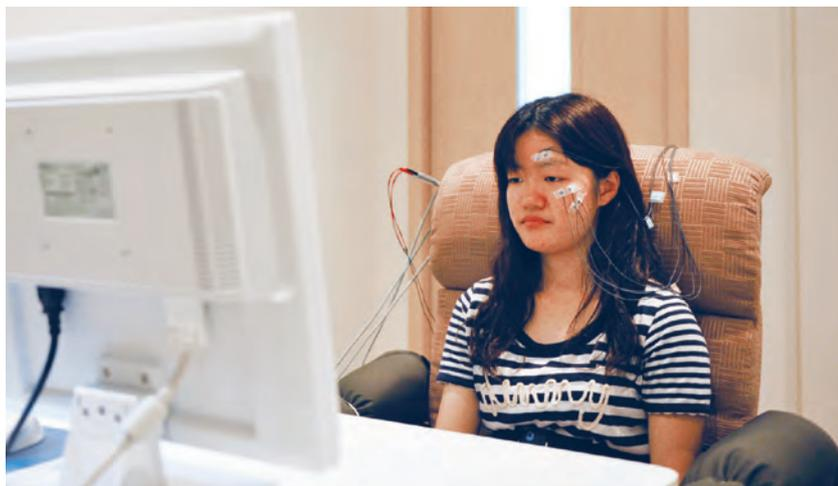
外界からの刺激を遮断した室内で、モニターに情動を喚起する絵や文字などを表示し、その際の発汗や心拍数、顔の筋肉の動きなどを計測する。そのデータをもとに情動情報がどのように表れるかを解析する。
