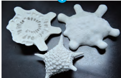
マイクロCTで得られたデータをもとに、対象の立体構造を拡大して再現した石膏模型を作り出す。0.1mm単位の薄い層を重ねて作るため、1つを再現するのに数時間かかる。断面の形状も再現可能だ。
