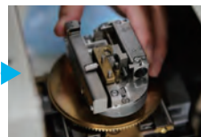
観察したい対象を設置する。電子線を別の金属にあて、出てきたX線を使用する。
