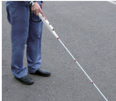
1m以上離れた前方の障害物をセンサで感知。グリッパリストバンドが振動して障害物の存在を伝える。
