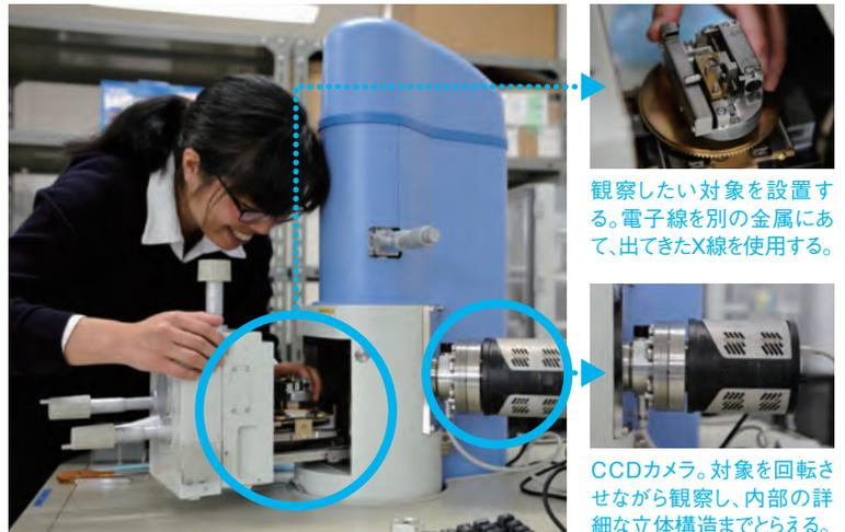
観察したい対象を設置する。電子線を別の金属にあて、出てきたX線を使用する。
