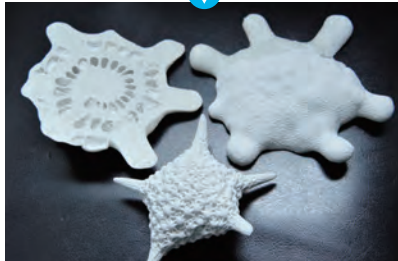
マイクロCTで得られたデータをもとに、対象の立体構造を拡大して再現した石膏模型を作り出す。0.1mm単位の薄い層を重ねて作るため、1つを再現するのに数時間かかる。断面の形状も再現可能だ。
