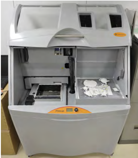
マイクロCTで得られたデータをもとに、対象の立体構造を拡大して再現した石膏模型を作り出す。0.1mm単位の薄い層を重ねて作るため、1つを再現するのに数時間かかる。断面の形状も再現可能だ。
