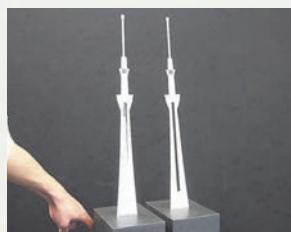
左:サイエンス・ミニトークは実験や実演を含め約15分間。中:トークで使う実験映像。右が従来のタワー、左が東京スカイツリー。中心部の心柱の有無によって揺れが変わることを実演。右:トークの内容はほかの科学コミュニケーターとも共有する。
