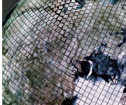
3mmドットピッチの面発光によって、これまでにない細密な映像を実現。コントラストも格段に向上している。
