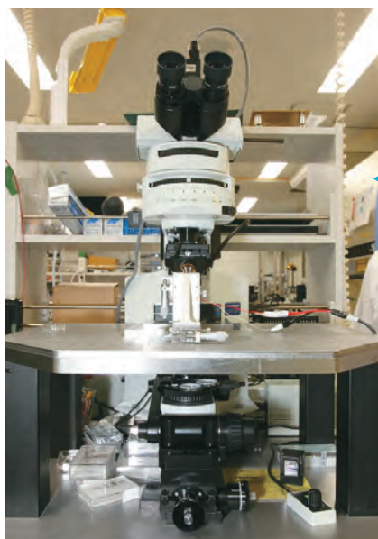
MMTによる細胞操作のための顕微鏡システム。顕微鏡自体は一般的なものだが、観察対象を置く部分に磁気駆動ステージが設置され、そこにMMTを組み込んだマイクロ流体チップをセットする。
