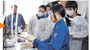
安全に留意しつつ、高分子の溶液で参加者が各自、分離膜を作製、その後、性能評価のための試験を行った。
