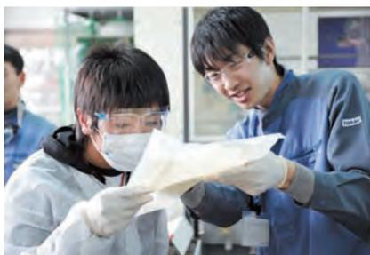
指導員のアドバイスを受けながら、作製した膜を、枠の大きさに合わせて慎重に切り取っていく。
