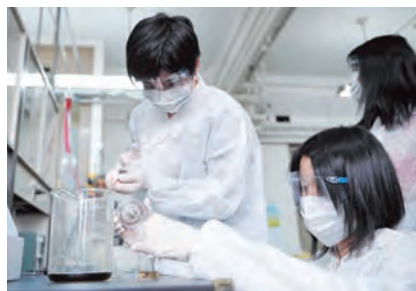
分離膜作製後の性能試験では、純水のろ過速度とフミン酸の溶液を用いたフミン酸阻止性能を調査した。
