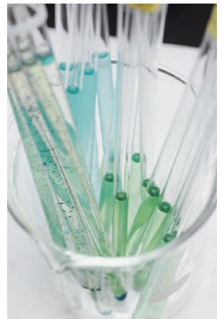
試験管の下方の青系の色の部分には金属イオン、上方の透明な部分には有機配位子が溶けており、その界面に多孔性金属錯体が合成される。
