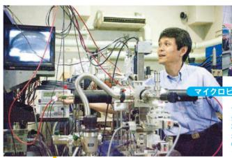
今回の研究のために新たに開 発した装置。ビームは通常、真空 状態でないと利用できないが、先 が細くなった管に通し、出口を薄 い膜で閉じて透過させることで、 1気圧での計測を可能にした。
