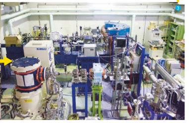
①ビームの方向を変える部分。 ビームは5階部分で高電圧を かけて発生させ、そこから1階ま でまっすぐ下に降りてくる。そ のビームに高い電圧をかけて 曲げ、横向きにさせる。
