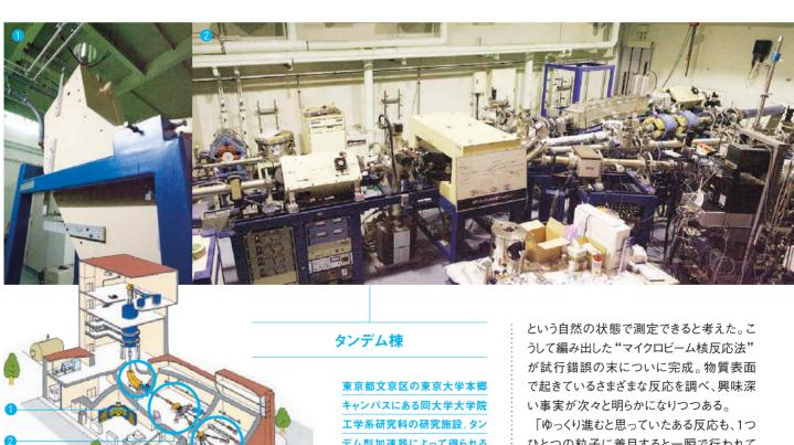
キャンパスにある同大学大学院 工学系研究科の研究施設。タン デム型加速器によって得られる イオンビームを利用して実験を 行う。"タンデム"とは2頭立て の馬車のことで、加速管が2本あ ることに由来する。
