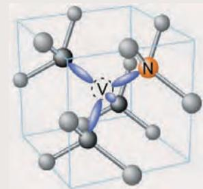
ダイヤモンド中のNV中心。Nは窒素原子、Vは炭素原子が抜けた空孔。
