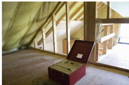
4階建木造試験体の屋根裏にセットされた地震計。随所に地震計が配置され、細かなデータを収集。
