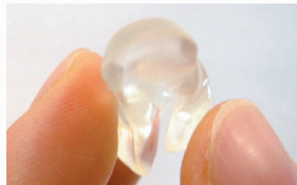
出来あがったアクアマテリアルはお菓子のグミのような触感を持ち、折り曲げても簡単には切れない。
