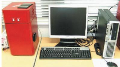
新しく開発された技術により、従来技術と比べて必要なサンプル量は微量に。また、CCD画像処理による簡易な測定装置を実現しました。今後、多項目測定も実現化していく予定です。
