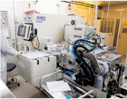
この装置でシリコンウエハ上にPZT薄膜を形成。加速度センサーの重要な材料だが、薄膜形成自体が難しい。
