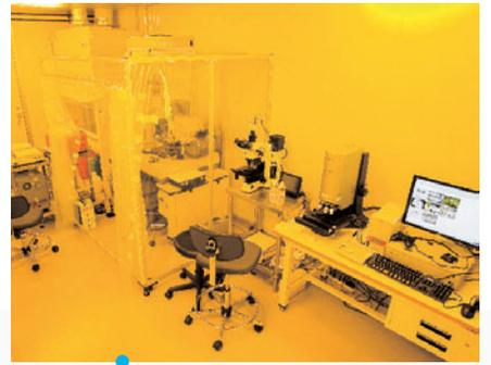
フォトエッチングをする部屋。フォトレジストが感光してしまわないように黄色い照明を使っている。
