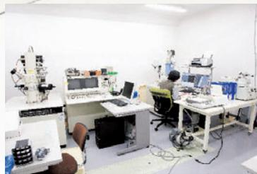
薄膜の状態などを調べる高分解能のもの、簡便に扱えるものの2種類の電子顕微鏡がある。
