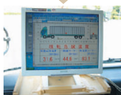
動揺・振動解析ユニットで車両全体の重心位置を検知
