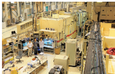
SPring-8では、全周1436メートルにもなる円形の軌道に電子を周囲らせ、そこから62本のビームラインを設置することができます。現在は49本が稼働中で、秋山博士はそのうちの1本「理研ビームラインBL45XU」を使用。
