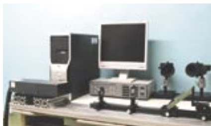
流体計測システム フローテック・リサーチが開発したFTR-PIV Stereo。
