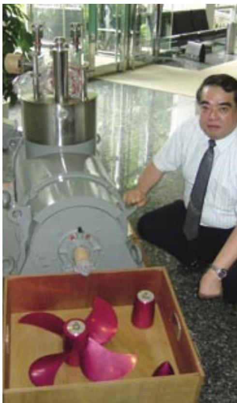
上:「マイスナー効果」と呼ばれる現象で浮か上がる超電導材。(超電導工学研究所提供) 下:高温超電導材を使った超電導工学研究所の船舶用モーター。
