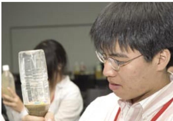
地盤液状化の実験に取り組む高校生。丸ピンの頭が砂から現れたところ。
