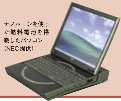
ナノホーンを使った燃料電池を搭載したパソコン (NEC提供)
