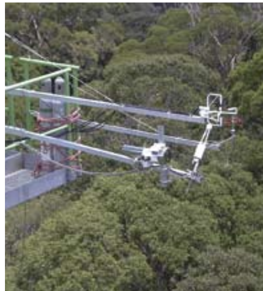
左は蒸散量(フラックス)の測定装置。右はクレーン講習中の研究員。研究人材の養成は現地でも大きな課題。大がかりな装置を使うための許認可など、制度上のすり合わせが必要となることもあり、人づくりや体制づくりにもアジアの協力が求められている。
