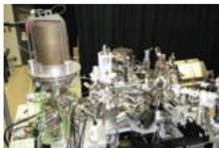
スピンSEM(走査電子顕微鏡) 物質の磁化の状態を可視化する一つの方法がこの装置。
