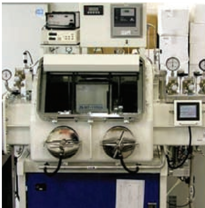
電気炉内蔵型グローブボックス 極低酸素下で拡張熱処理をする
