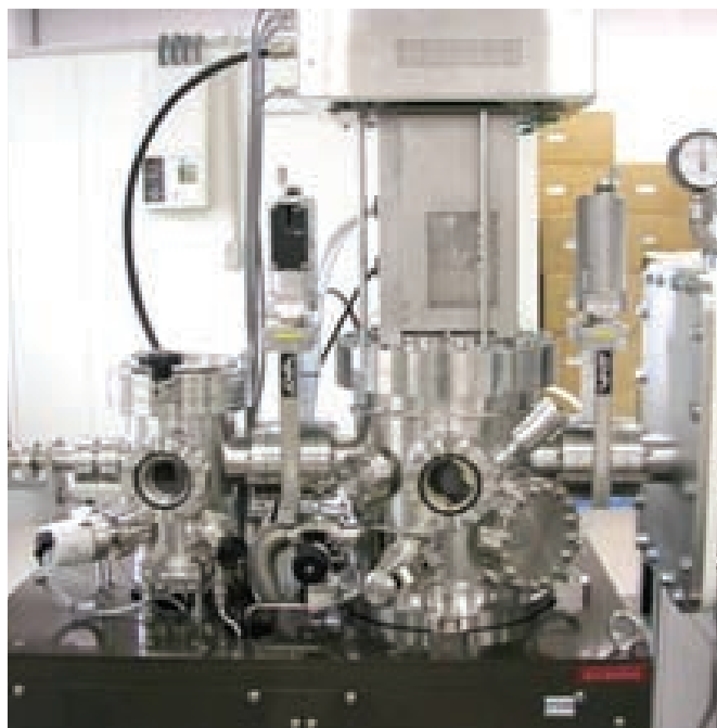
3次元スパッタリング装置 希土類金属を立体的に被覆する
