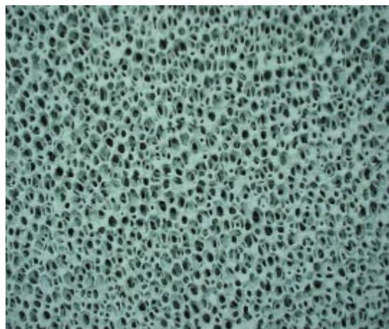
図2 光触媒担持セラミックスフィルター
