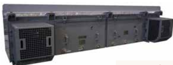
フルSiC適用インバーター装置
