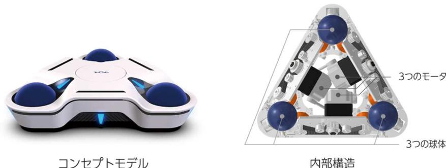
図 球駆動式全方向移動機構
